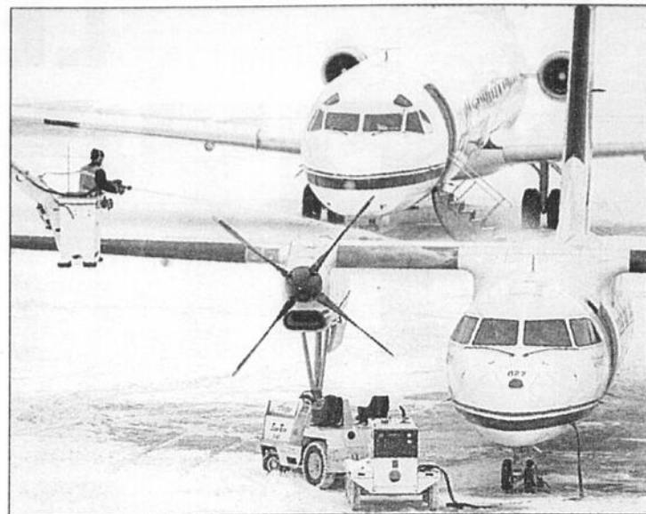
DÉGLAÇAGE - Un employé de l'aéroport international de Spokane, dans l'État de Washington, déglace les ailes d'un avion.
