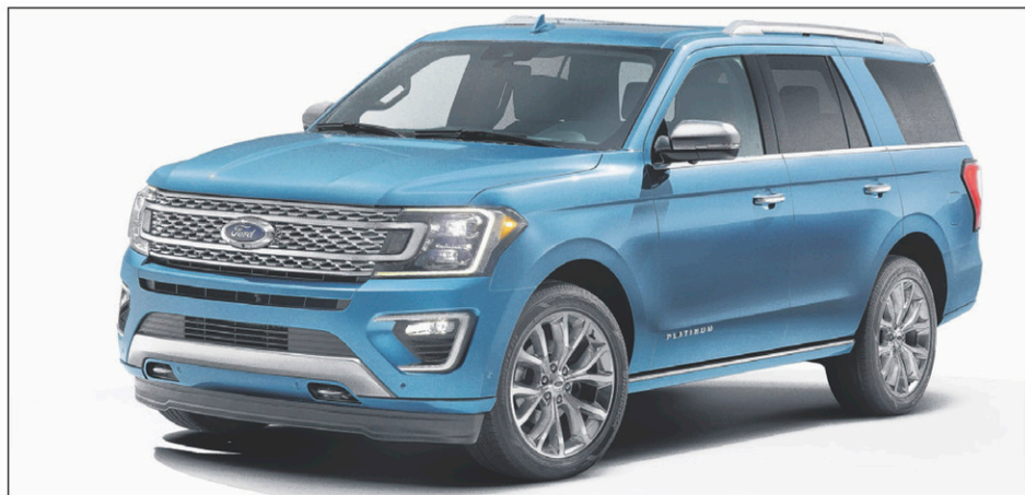
Le Ford Expedition a été allégé de 137 kg (300 lb). Le groupe motopropulseur comprend un V6 biturbo de 3,5 l et une nouvelle transmission à 10 rapports.
