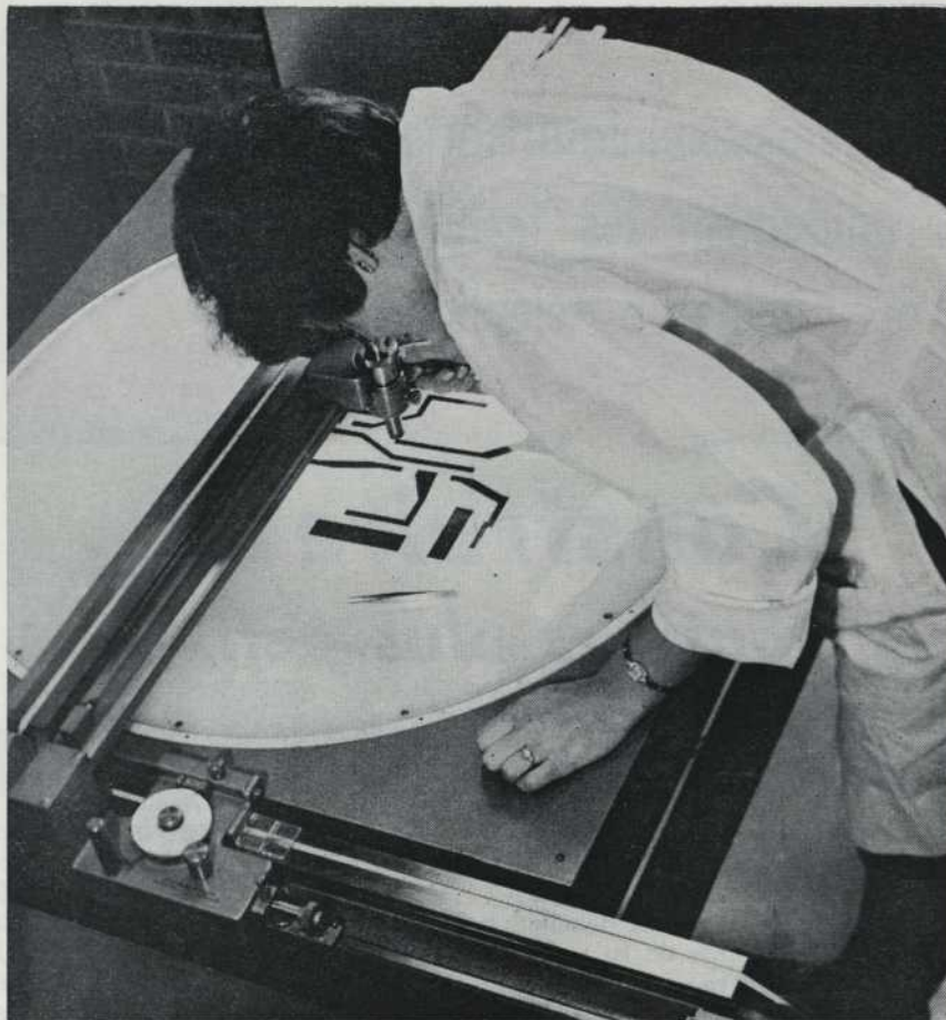
Le circuit initial est fabriqué par couches successives pour former ce que l'on appelle un « cache ». Le cache représenté ici est bien plus grand que le circuit lui-même. Lorsque la technicienne aura terminé son travail, le cache sera réduit par un procédé photographique.
