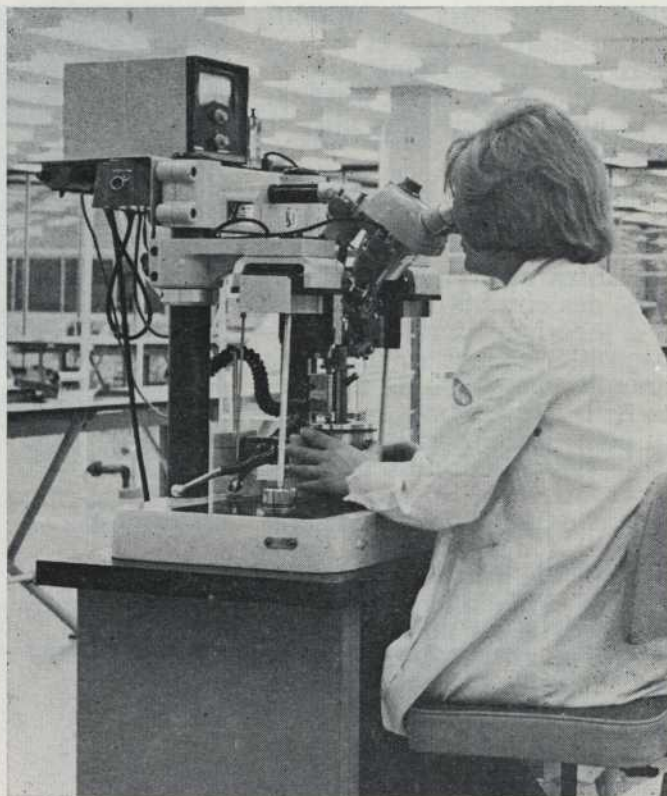
Une chaîne de production de l'ère spatiale. Les techniciennes doivent se servir de microscopes pour assembler les circuits miniaturisés. Des machines à souder sont employées pour relier des fils de connection extérieurs.
