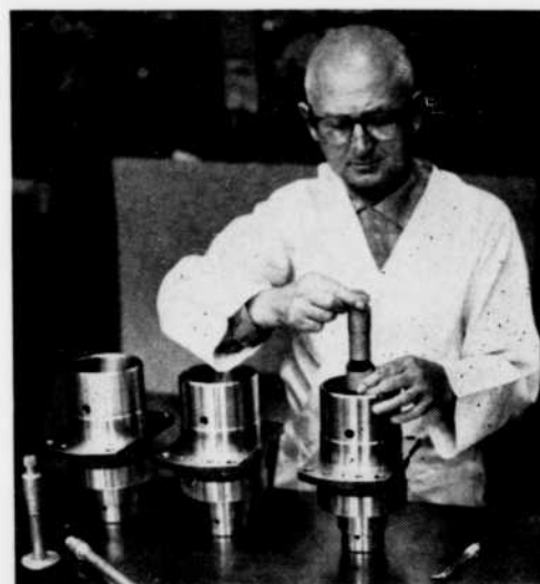
Les cylindres en acier inoxydable, ainsi que toutes les pièces employées dans le mécanisme de l'interrupteur, subissent une vérification complète pour assurer un rendement stable.
