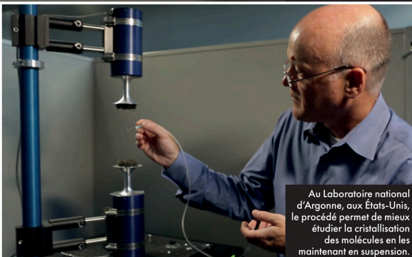
Ces gouttes, pouvant contenir différents composés pharmaceutiques, restent en suspension grâce aux ondes acoustiques.
