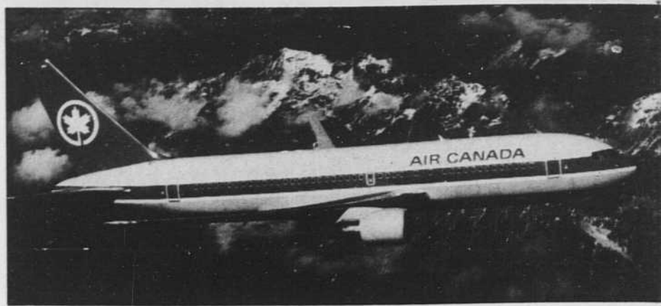
Le nouveau Boeing 767 d'Air Canada est d'une finesse rare et dans des conditions de vol normales, son rendement énergétique est supérieur de 27 % à celui du DC-8 qu'il remplace.
