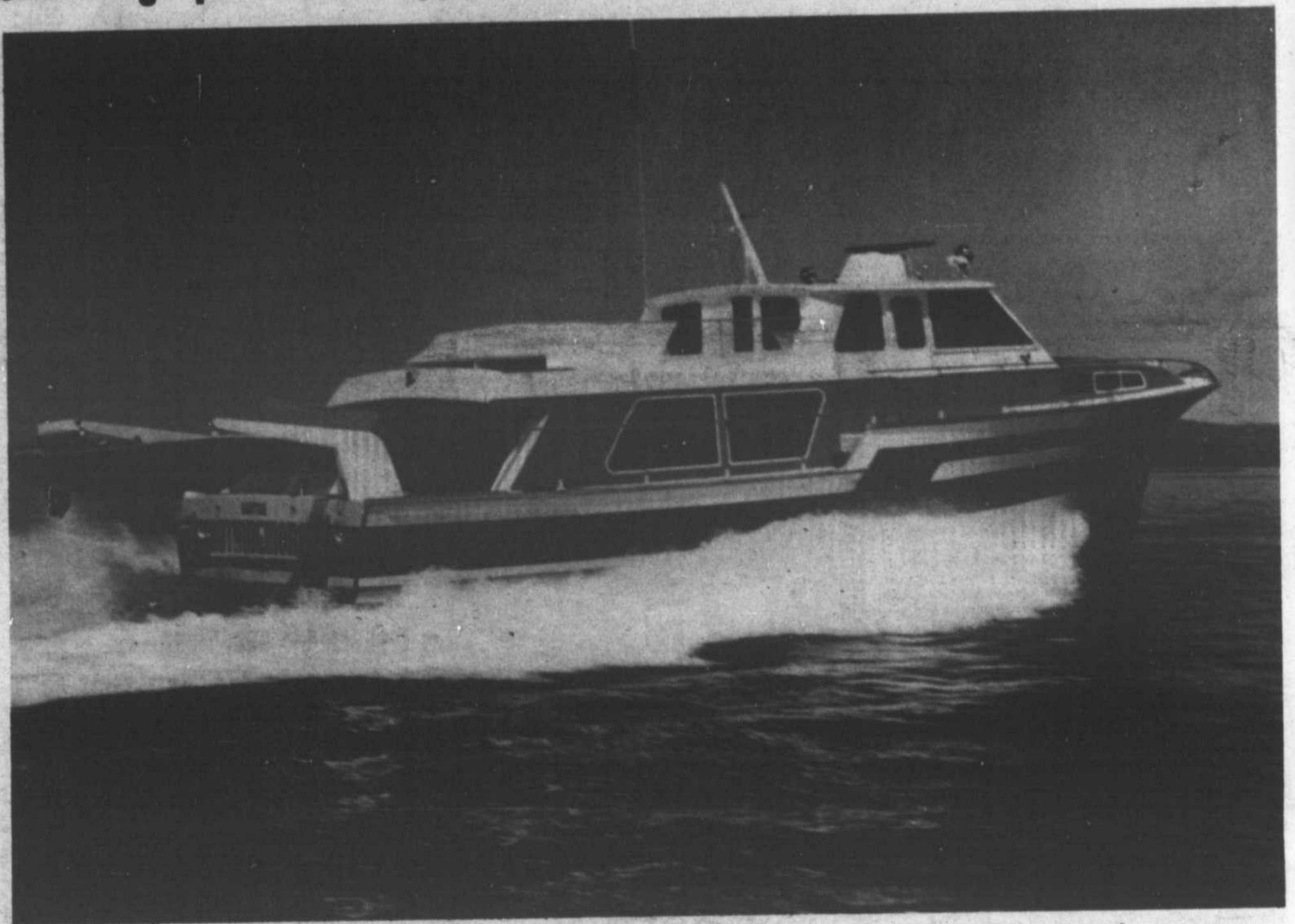
Le "Nothing More", un bateau de plaisance luxueux et rapide propulsé par deux turbines à gaz ST6 de United Aircraft du Canada Limitée, est montré ici naviguant à 30 noeuds. Ce
