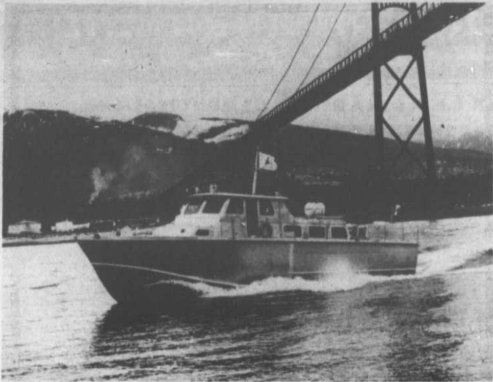
Le bateau de service "Nechako" construit en aluminium et mesurant 72 pieds, est propulsé par deux turbines à gaz ST6 de United Aircraft du Canada Limitée. Il fournit un moyen de transport rapide aux employés de Alcan à Kilimat et Kemano, en Colombie Britannique.
