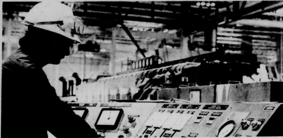
A l'usine Lapointe, les opérations de coulée, laminage et bobinage sont synchronisées manuellement lors du démarrage. Une fois les vitesses et les tensions ajustées le travail se poursuit automatiquement.
