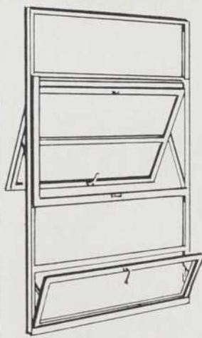
Fenêtre en Saillie Truscon en Aluminium avec Bourrelet d'Étanchéité
