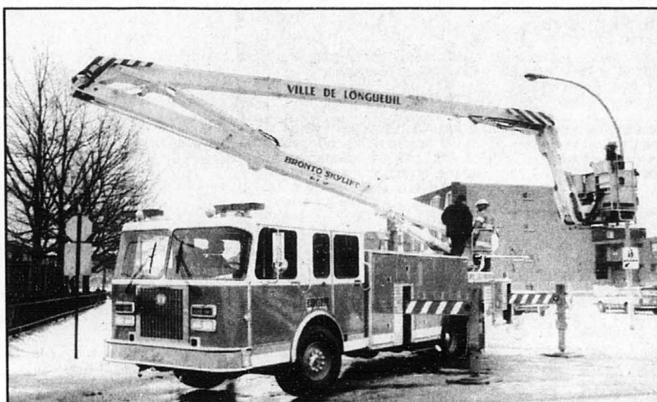
La plate-forme élévatrice articulée qui peut atteindre une hauteur de 27 mètres.
