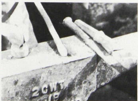
Figure 47. L'artisan recommence le martelage jusqu'à ce que le fer s'amincisse au point de devenir tranchant à son extrémité tout en prenant une forme légèrement évasée.
