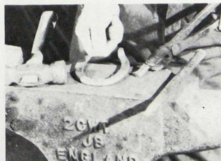
Figure 125. Pour faciliter la fusion des métaux l'artisan saupoudre d'anti-borax la surface du métal qui doit recevoir la pince. Nég. 76.1235.23 (35).
