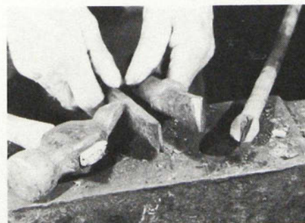
Figure 50. Il faut ensuite que cette incision soit élargie à l'aide d'une plus grosse tranche. Nég. 76.1230.25 (35).
