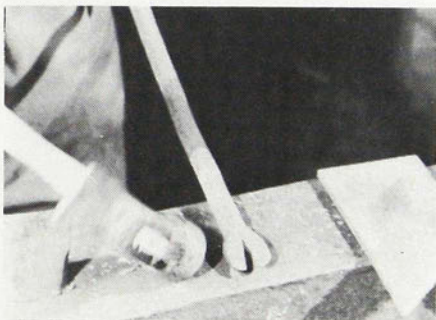
Figure 52. C'est de cette incision que l'outil tire son nom de pied-de-biche. En fait il s'agit de l'arrache-clous proprement dit. La finition de cette partie de l'objet se fait par un léger martèlement de la surface et des rebords de l'arrache-clous. Nég. 76.1230.30 (35).
