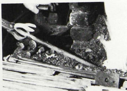
Figure 59. L'artisan commence par faire rougir l'autre extrémité de la barre de fer. Cette fois il doit utiliser des tenailles pour tenir le morceau, la partie travaillée étant encore trop chaude pour être prise à mains nues. Nég. 76.1232.14 (35).
