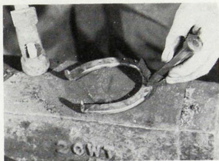
Figure 129. Il faut ensuite percer les trous destinés à recevoir les clous. Avec un centre-poinçon l'artisan marque le fer à l'endroit précis où il va percer les trous. Le perçage s'effectue à chaud avec un poinçon. Huit trous au total sont percés; quatre d'un côté et quatre de l'autre. Nég. 76.1233.34 (35).
