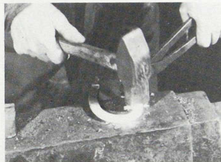
Figure 124. Il s'agit ensuite de poser la pince après avoir préparé le métal pour la recevoir, en le martelant avec le marteau sur l'enclume pour l'écraser et l'aplatir. Cette partie du fer étant préalablement chauffée, l'artisan utilise alors un marteau un peu plus lourd pour lui donner une surface plane. Nég. 76.1235.20 (35).
