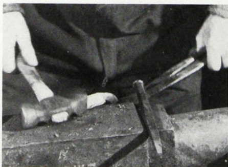
Figure 128. Avec le marteau affûteur l'artisan procède ensuite à l'aiguisage de la pince. Nég. 76.1235.30 (35).
