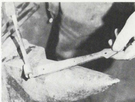
Figure 89. Puis s'aidant de tenailles et du marteau il écrase la partie chauffée en la martelant sur la table de l'enclume de façon à ce qu'elle puisse entrer dans l'oeil de la penture.
