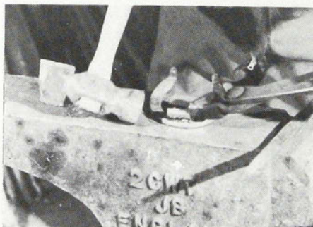
Figure 127. Ensuite, il enfonce légèrement la pointe de la pince dans le fer avec le marteau. La soudure s'opère par le martelage à chaud de la pince. Nég. 76.1235.30 (35).
