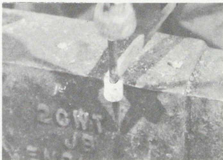
Figure 84. En s'aidant du poinçon et du marteau l'artisan donne la dimension voulue à l'ouverture. Il termine ensuite l'opération sur la tête de la bigorne. Nég. 76.1233.34A (35).
