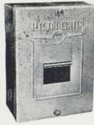
Boîte 6-1/8" H., 4-1/8" W., 3" D. Electri-Centres No 2000. Le dispositif fondamental comprend une boîte avec neutre et devant (type encastré ou en surface). Pour 1 ou 2 circuits. A trois fils, 120 - 240 V., C.A.
