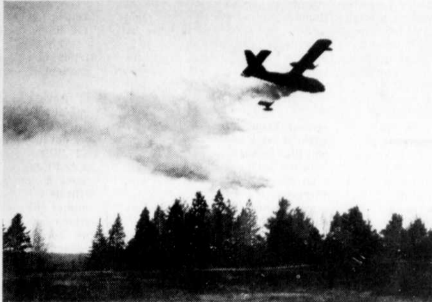
L'impressionnant CL-215 à l'oeuvre... Il peut déverser 1,200 gallons d'eau à la fois.
