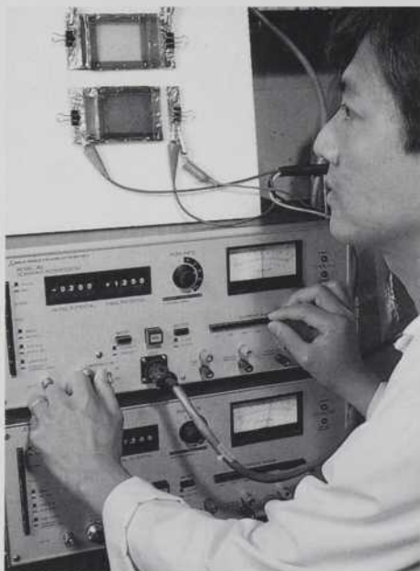
La fenêtre intelligente peut, selon les modifications apportées à sa transparence, moduler l'entrée de chaleur dans une pièce.
