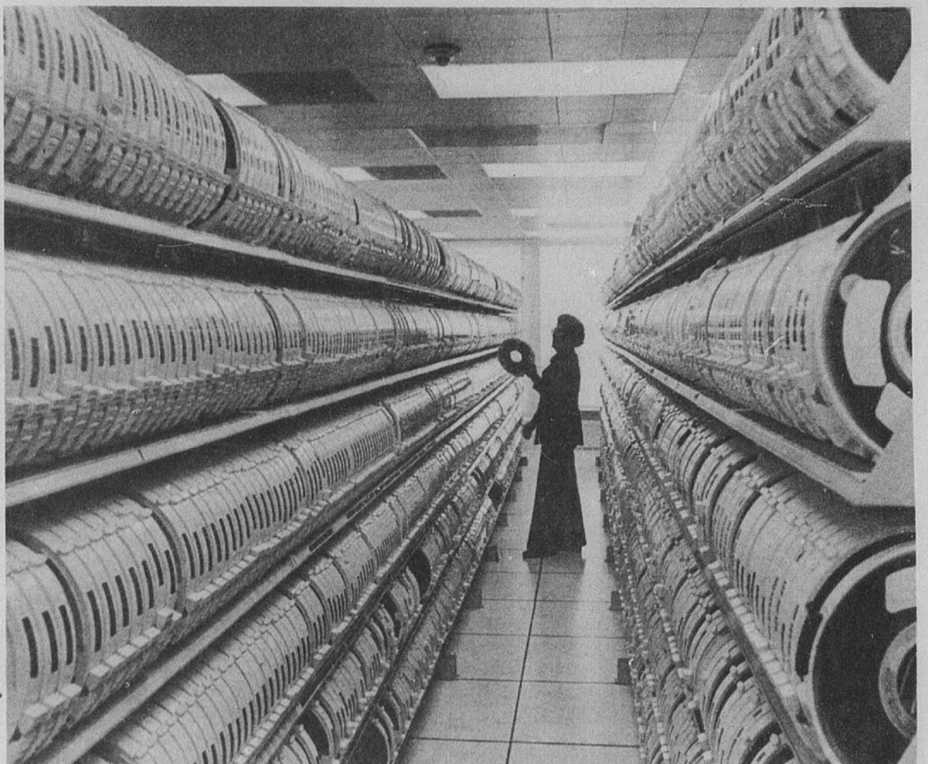
Chacune de ces bandes magnétiques, enroulée sur sa bobine de 12 pouces de diamètre, peut contenir jusqu'à 180 millions de lettres ou de chiffres.
