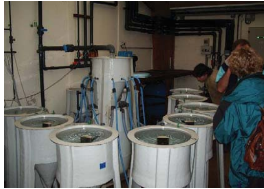
Filtre à sable et filtre biologique avec argile expansée et unité de recherche avec petits bassins à fond conique
