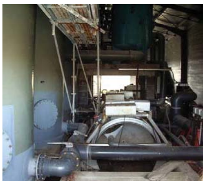
Système de traitement des eaux des bassins de préengraissement (filtre à tambour et cylindre de filtration biologique)
