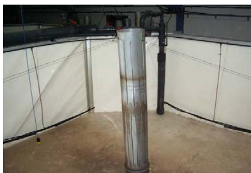
Bassin de 50 m 3 en acier avec membrane et crépine et drain au centre
