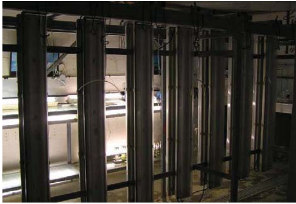
Système pour la production de phytoplancton et cuves de production des rotifères
