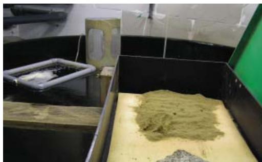
Distributeur à courroie pour aliment artificiel et écumeur pour maintenir la surface de l'eau libre de toute matière, en particulier les huiles provenant de l'alimentation
