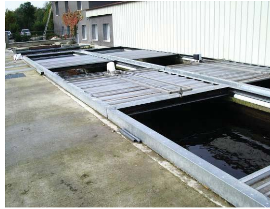
Robot d'alimentation sur monorail et bassins des géniteurs avec panneaux pour les contrôles photopériodiques
