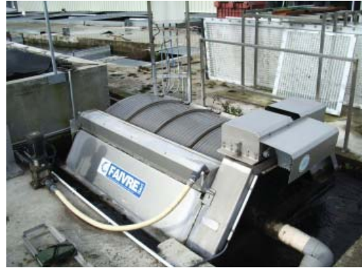
Photo de Monsieur Murgat avec vue d'ensemble des bassins extérieurs de type « raceway » et vue du filtre à tambour à la sortie de cette première section
