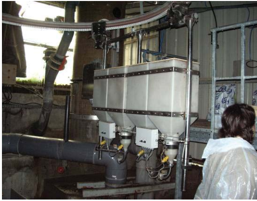
Robot d'alimentation sur monorail et bassins des géniteurs avec panneaux pour les contrôles photopériodiques
