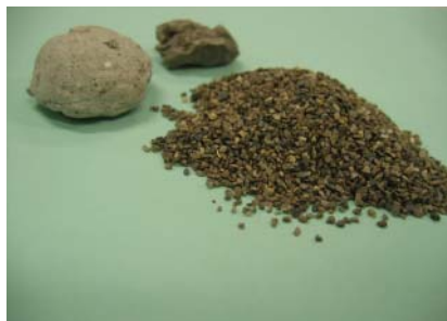
Argile expansée de différentes grosseurs ou granulométrie et perte du système de traitement final de l'eau à la sortie de la station expérimentale
