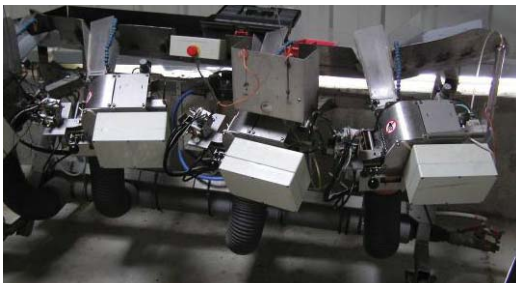
Appareil de vaccination automatisé et bassins rectangulaires à fond circulaire pour juvéniles
