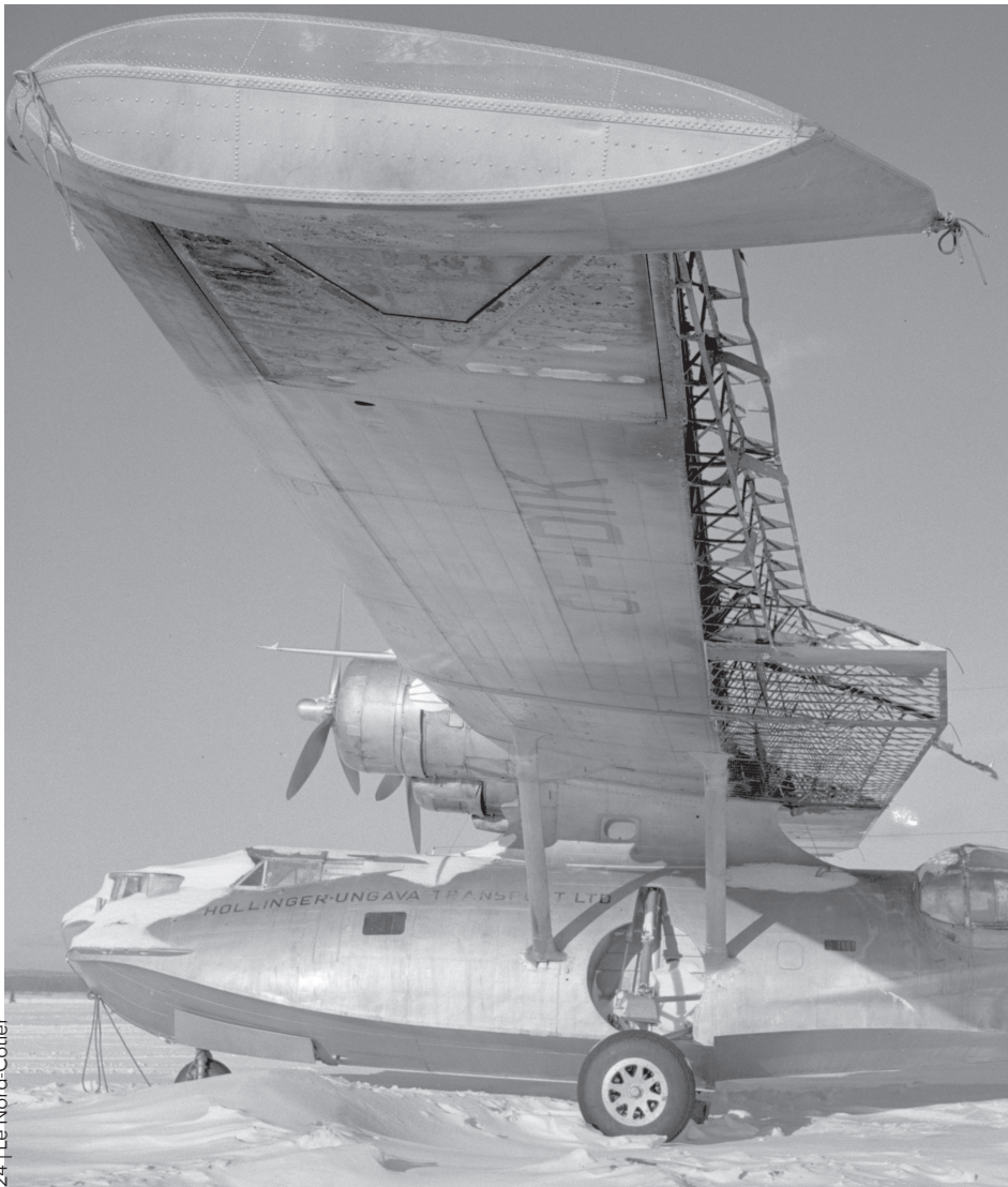
L'aile de cet avion Canso CF-DIK a été endommagée par un incendie causé par une chaufferette défectueuse. Deux employés de la Hollinger Ungava Transport qui effectuaient des travaux sous l'aile de l'avion, Paul Blanchette et Claude Rolhion, ont échappé de peu aux flammes, lesquelles se sont propagées à l'abri qui les protégeait des conditions hivernales. Les deux hommes se trouvaient sur un échafaudage recouvert de toiles goudronnées lorsque l'incendie s'est répandu. Les dommages à l'avion sont estimés à quelques milliers de dollars. 19 janvier 1953. Archives nationales à Sept-Îles, fonds Compagnie minière IOC (P21, 3323). Photographie non identifié. Source : L'Avenir and Sept-Îles Journal, 30 janvier 1953, vol. 1, no 10, p. 1.
