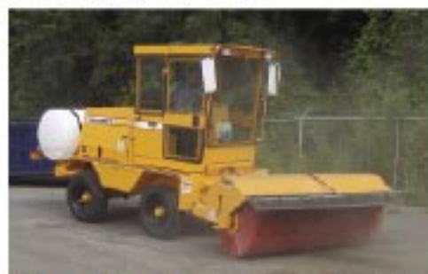
Balai Rosco Challenger III robuste, idéal pour les tâches les plus exigeantes, brosse à changement rapide (moins de 5 min), moteur Cat 80 hp, entraînement hydrostatique
