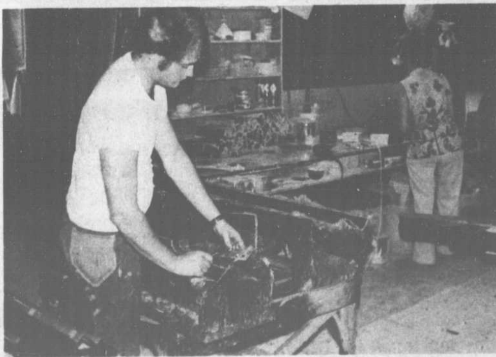
L'un des fils de M. Boisvert s'apprête ici à couper les excédents de fibre de verre d'après un moule.
