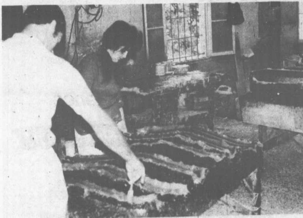
Le fibre de verre trempé de résine, vient d'être déposé sur les moules; on voit ici le laminage qui débute. Comme on peut le remarquer on procède avec un pinceau et un rouleau.
