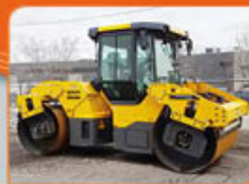
Rouleau tandem Dynapac largeur de 35 à 84 pouces
