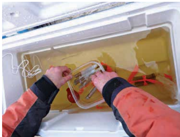
Capsules d'incubation avant leur implantation dans les frayères
