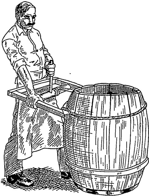
28. Le serrage au moyen du virevau. Dessin de Pierre Thériault.
