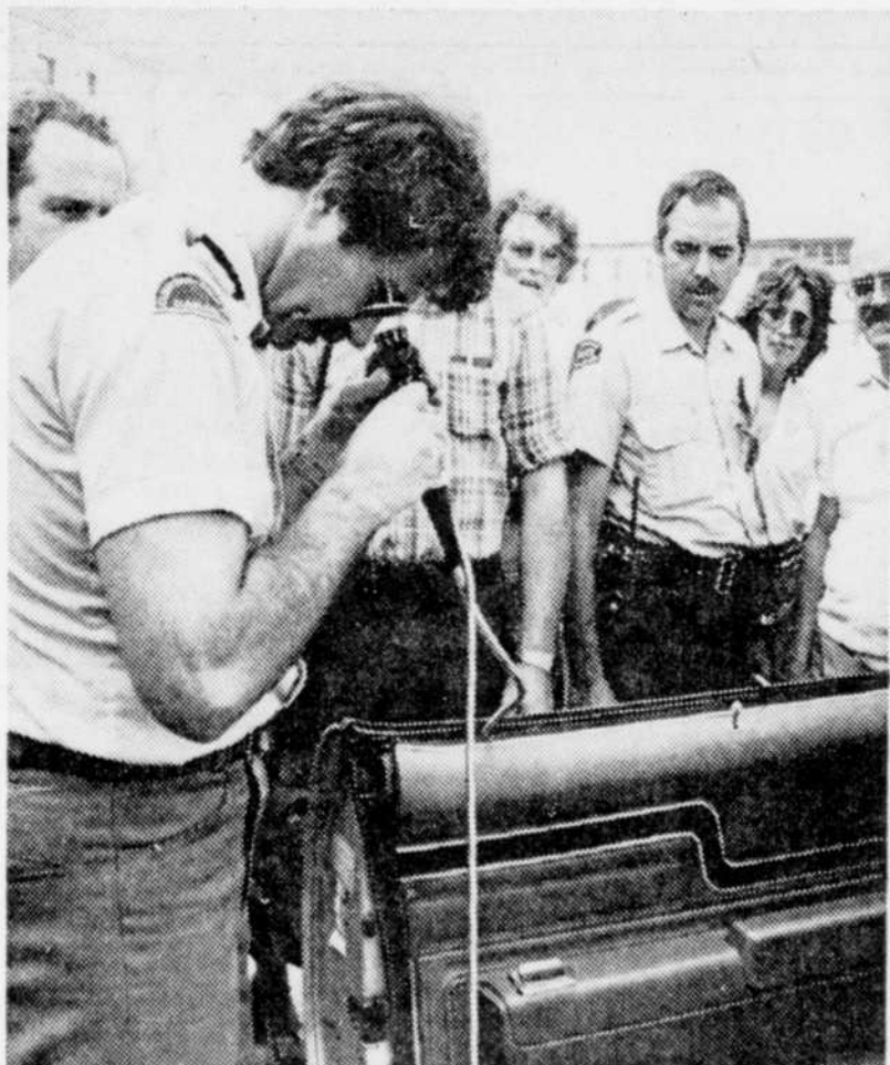
Le "fibroscope", un nouvel appareil qui permet de fouiller les recoins d'un véhicule suspect sans l'endommager.
