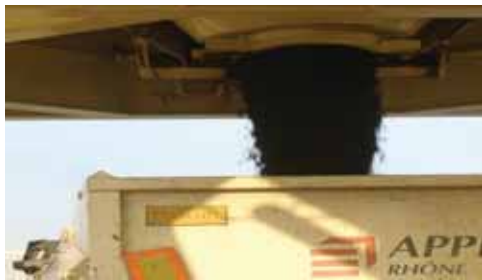
Photo 3. Chargement sans fumées d'un camion d'Appia Rhône à la centrale SRB (Société Routière du Beaujolais, Belleville/Saône, France) // No fume emissions during the discharge in a Appia Rhône lorry tipper at SRB plant (Belleville/Saône, France).
