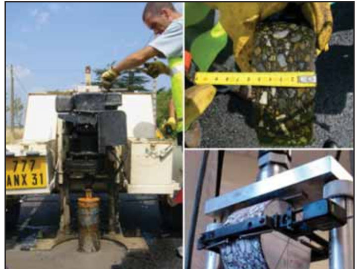
Figure 6. Carotte LEA® prélevée in-situ, puis testée en compression diamétrale // LEA® field core tested in IDT mode.
