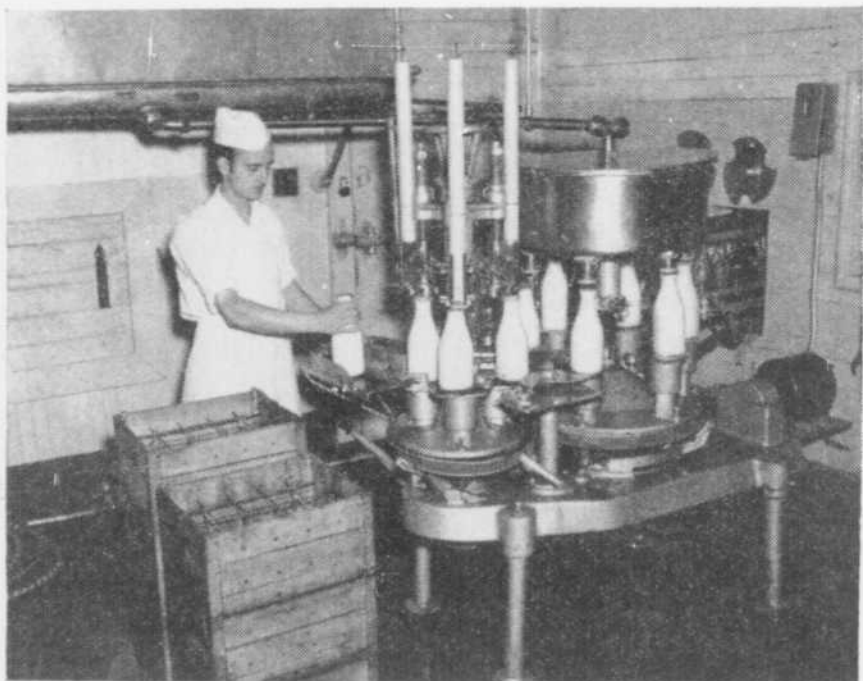
On voit ici M. Fernand Blackburn, préposé à l'embouteillage hygiénique à la Laiterie G. H. d'Arvida. Cette embouteilleuse moderne d'une capacité de 32 pintes à la minute, permet à la Laiterie G. H. de faire une distribution régulière de 10,000 pintes de lait tous les jours.
