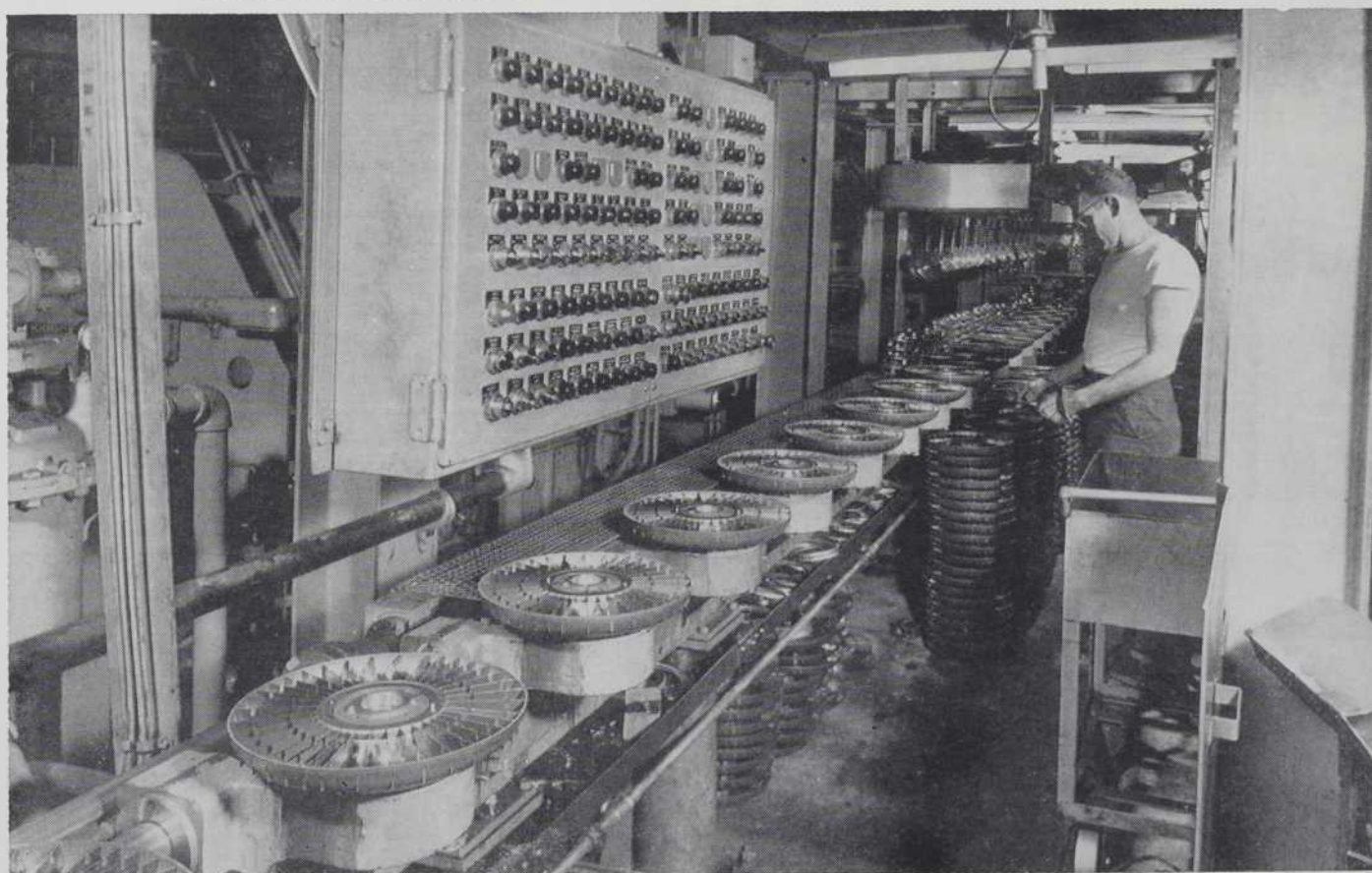
UNE VARIÉTÉ DE LUMIÈRES, FIXES SUR UN GRAND PANNEAU, AIDANT À DÉCOUVRIR TOUT TROUBLE HYDRAULIQUE OU ÉLECTRONIQUE DANS LA MACHINE D'ASSEMBLAGE.
