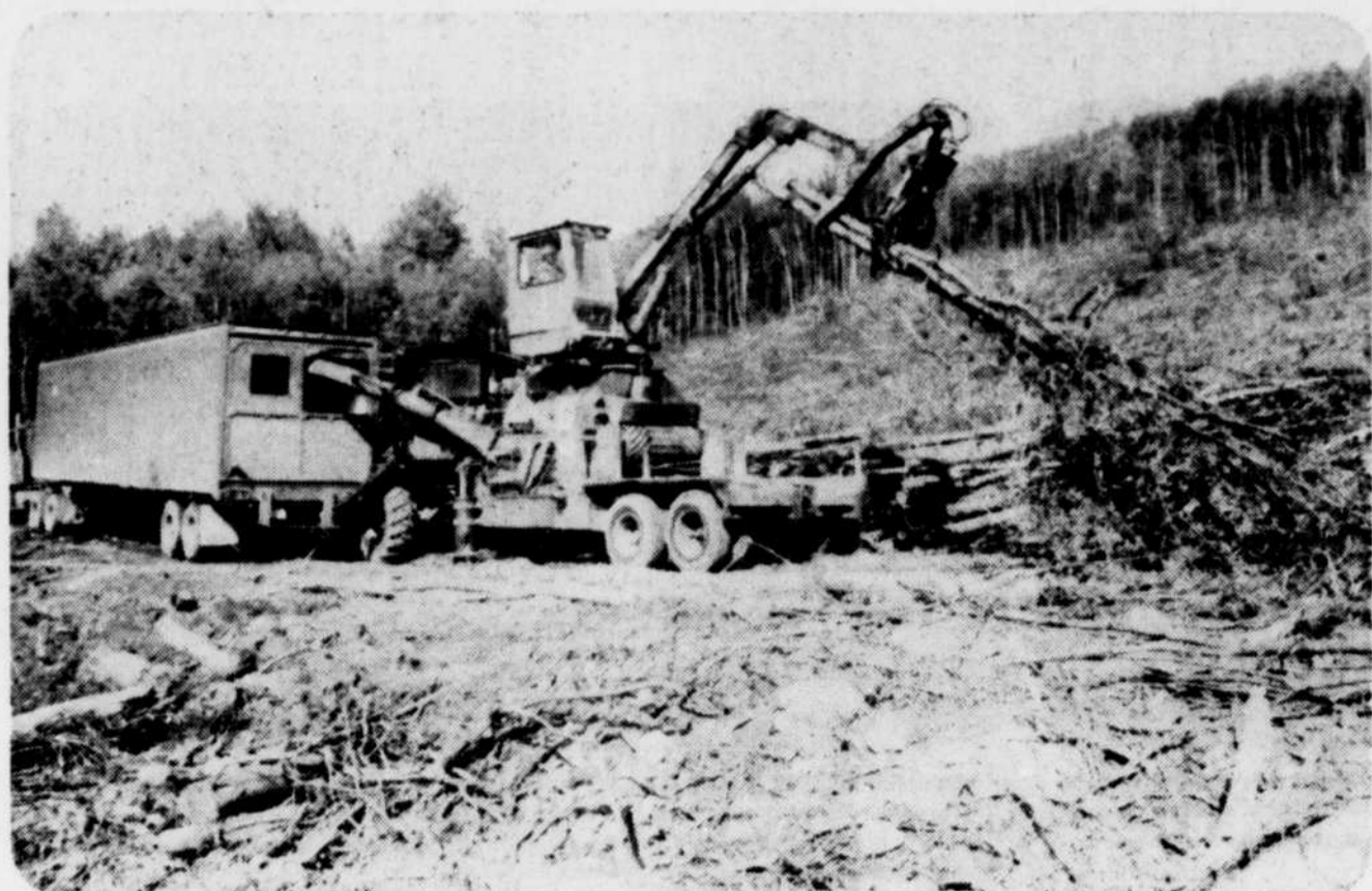
Cette déchiquteuse avale des dizaines d'arbres chaque jour et les transforme en copeaux de bois qui sont transportés par camion-remorque à l'usine de la CIP de La
