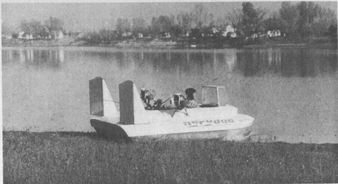
L'Aérodoo, aéroglisseur à deux places, est un véritable véhicule à coussin d'air (hovercraft). Il se déplace avec aisance au-dessus de la terre, de l'eau, de la glace et de la neige.
