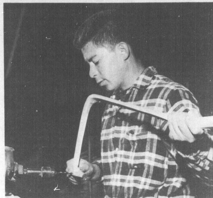
Au moyen d'une foreuse fixe, un jeune Indien perce les trous qui permettront à d'autres employés de lacer les bâtons de crosse fabriqués dans la seule usine de ce genre au Canada, qui vient d'être reconstruite grâce à l'aide du ministère des Affaires indiennes et du Nord canadien.
