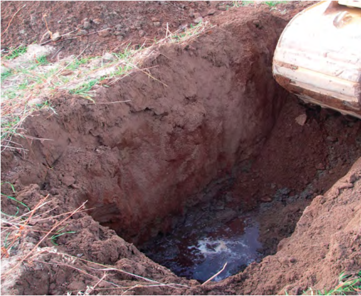
Photo 7 - Puits afin de déterminer la position de la nappe phréatique et de décrire le profil de sol.
