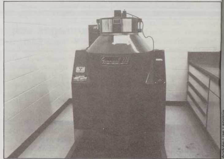
La bombe à cobalt de la faculté de l'agriculture de l'université Laval qui sert aux expériences sur le jus de pomme.
