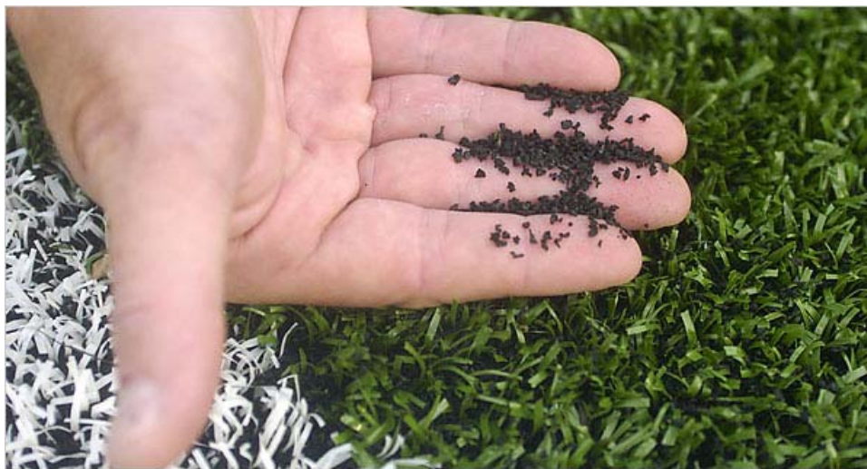
Figure 2. Photographie des matériaux d'un gazon synthétique avec granulats SBR
