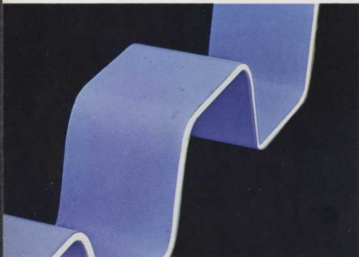
CINTRAGE Le revêtement n'est pas affecté par le cintrage normal. ▲
