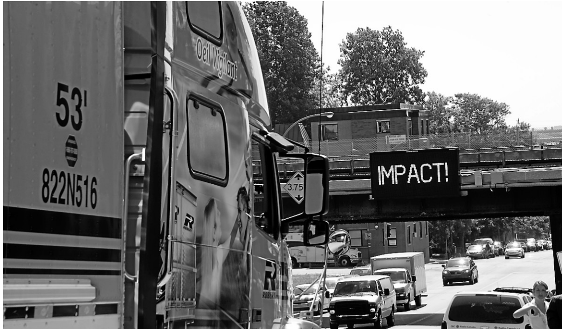
Lorsqu'un camion lourd roule dans la rue Guy en direction du viaduc, un détecteur laser capte sa hauteur et peut envoyer instantanément le message « Impact! »
