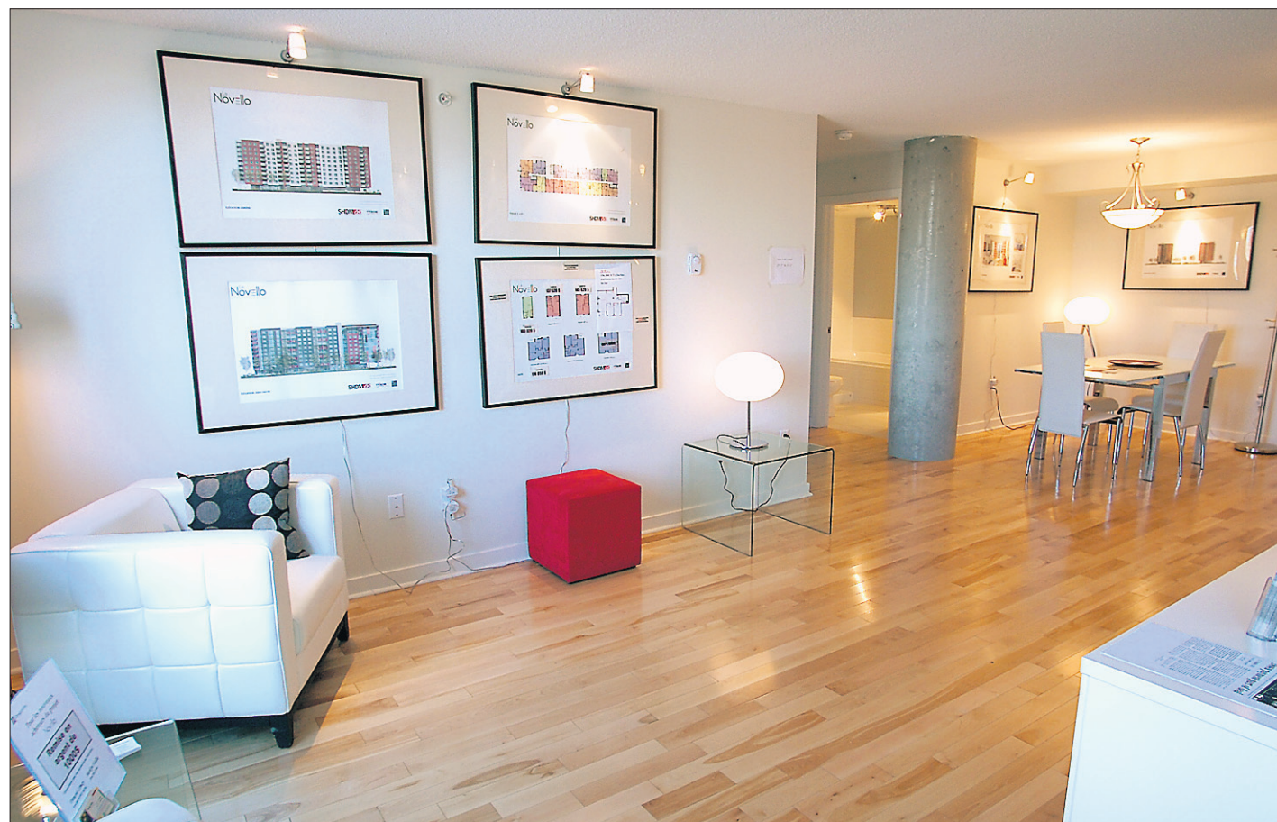
PHOTOS ANDRÉ TREMBLAY, LA PRESSE © Pour un style moderne, les colonnes sont en béton apparent, mais les plafonds sont recouverts de stucco pop-corn.
