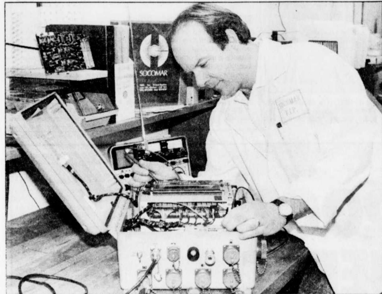
Gilles Alain, conseiller technique chez Soconav avec une station automatique pour enregistrer et transmettre les niveaux d'eau du Saint-Laurent.
