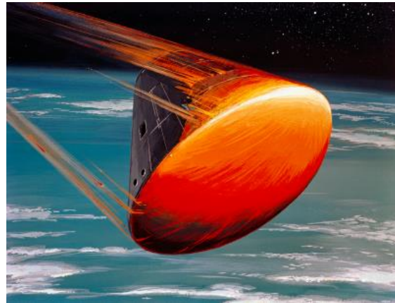
Rentrée dans l'atmosphère d'une capsule Apollo protégée par un bouclier thermique.
