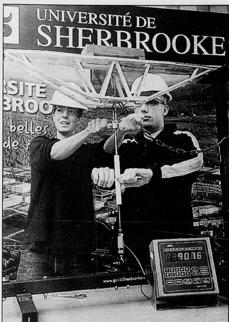
Imacom, Claude Poulin Éric Geoffroy et Mathieu Gendron, du cégep de Beauce-Appalaches, devaient soumettre leur pont à rude épreuve. C'est plutôt l'équipement de torture qui a failli céder. On a dû s'en remettre à un appareil hydraulique pour que le pont de bâtons de popsicle cède finalement.
