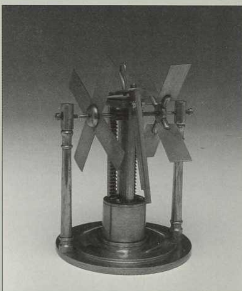
Un moulinet démontrant la résistance de l'air.
