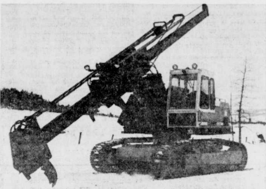
Ebrancheuse que fabriquera une firme de Notre-Dame-des-Pins.
