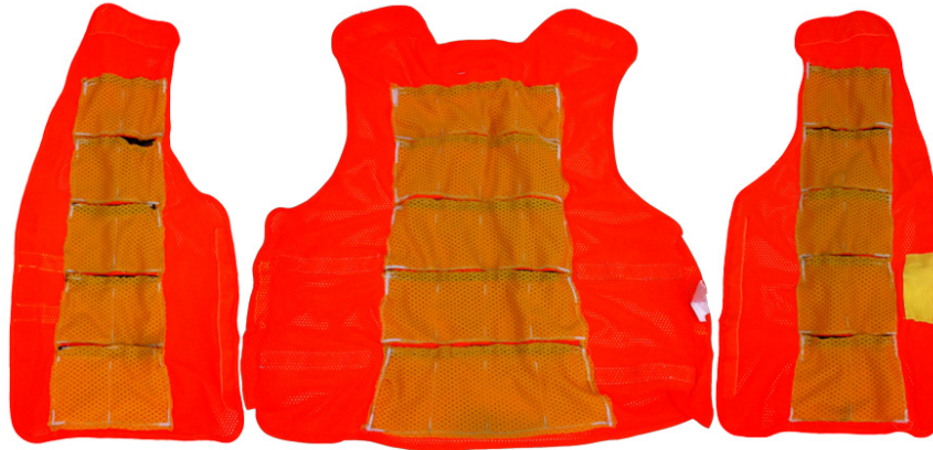
Figure 3.3 Prototypage de veste du volet 1, permettant de contenir les sachets de MCP dans leur forme assemblée.
