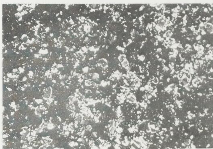
Fig. 1 — Aspect microscopique, en lumière polarisée, de la poudre de talc commerciale non colorée. Gross. 40 X.
