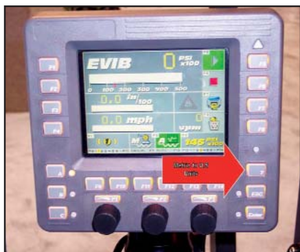
Figure 1 - Système de commande d'un compacteur « intelligent »
