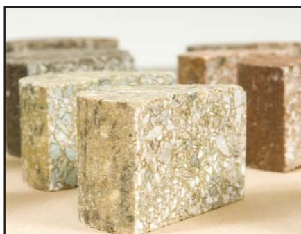
Figure 2 : Enrobé fait avec un liant végétal
