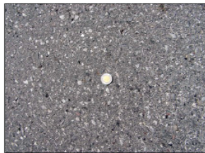
Photos 7 et 8 ESG-10 avec 3% de bardeau PC (bitume 0% mobilisable)
