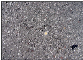
Photos 5 et 6 ESG-10 avec 3% de bardeau PC (bitume 40% mobilisable)
