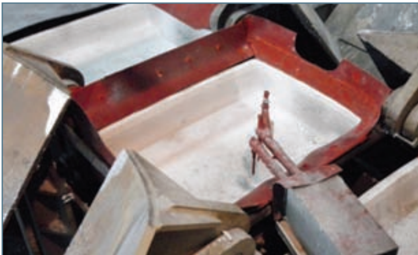
Prototype du garde anti-éclaboussure installé au point de coulée, dans la phase Améliorer.
