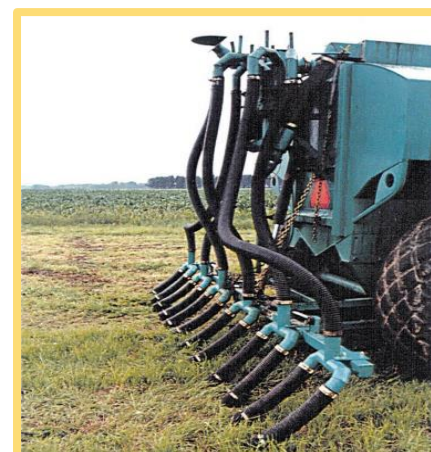
Rampe à prairie munie de pendillards Source : FPPQ. 2005. Fiche technique n° 5.
