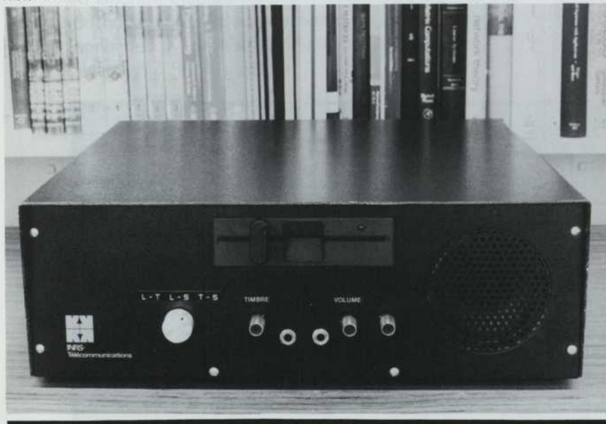
Synthétiseur de parole Loquax, capable de réciter en français un texte dactylographié.
