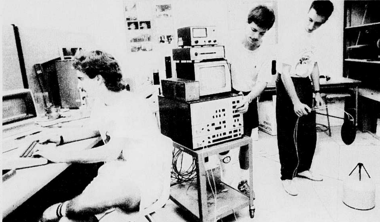
Luc Millette, au centre, étudiant en génie mécanique, qui fait sa maîtrise en acoustique, montre à un groupe de jeunes comment mesurer l'intensité acoustique, pour déterminer la puissance acoustique de la source. Se prêtent à l'expérience Yan Robichaud, de Québec, à l'ordinateur, et Pascal Robichaud, de Saint-Hyacinthe, à droite.
