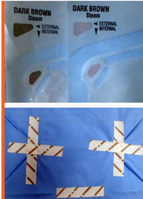
Fig. 2. Les indicateurs de type 1 sont typiquement intégrés aux sacs Steri-Pouch et aux rubans à autoclave.
