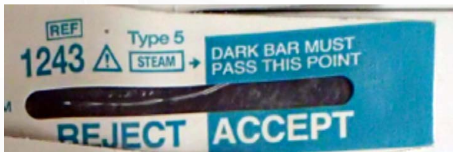
Fig. 4. Un exemple d'indicateur chimique de type 5. Ces indicateurs mesurent trois paramètres critiques du cycle et se rapprochent, sans les remplacer, des indicateurs biologiques.
