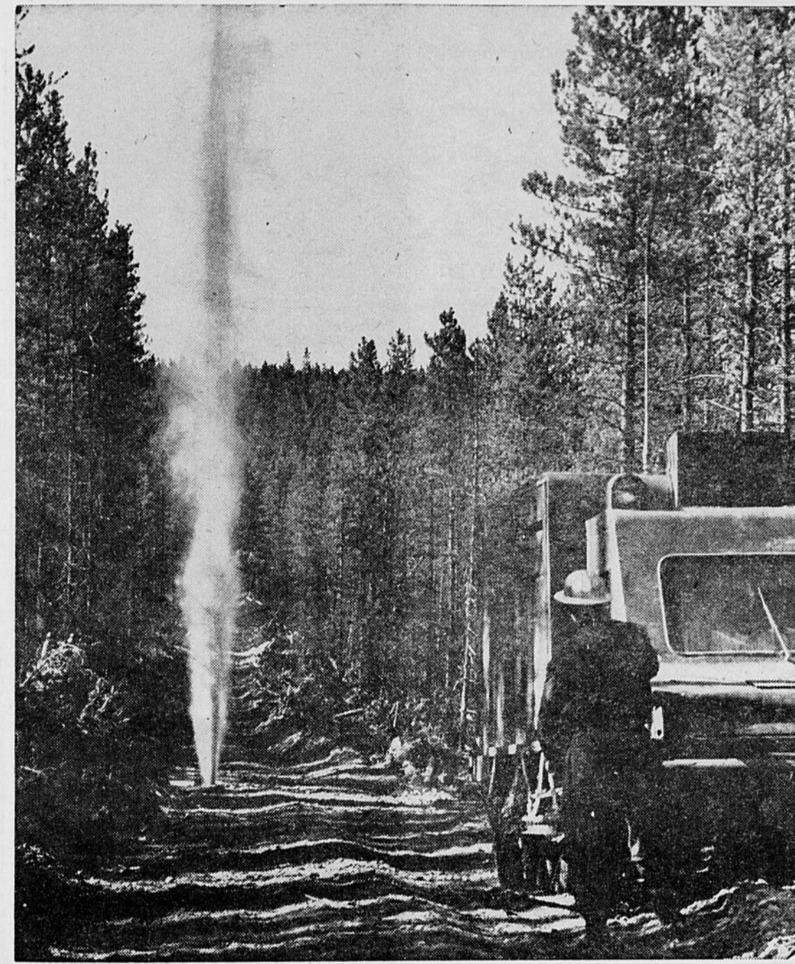
LA RECHERCHE DU PETROLE DANS LE QUEBEC — La British American Oil fait en ce moment des relevés sismiques sur son terrain de 100,000 arpents près de Mont-Joli dans la Péninsule de Gaspe. On voit ici, au coeur d'une forêt québécoise, une explosion dont les ondes sont enregistrées sur un appareil sensible dans le camion laboratoire. (Photo B.A. Oil).
