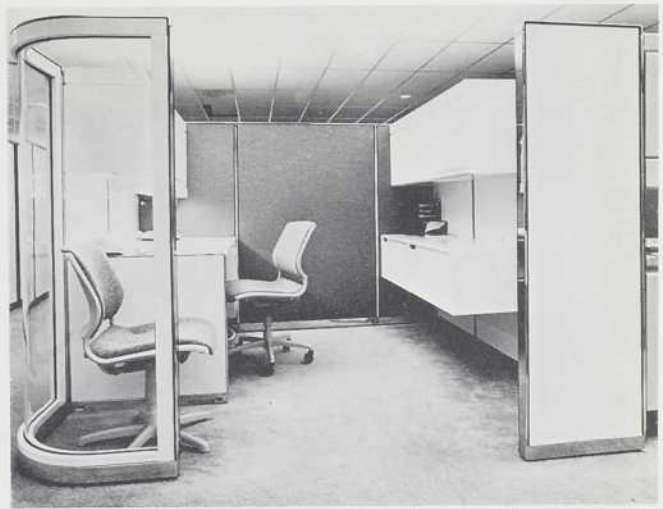
Un éclairage approprié: ce poste de travail transporte avec lui son système de distribution d'électricité et l'éclairage propre aux diverses fonctions de l'employé.
