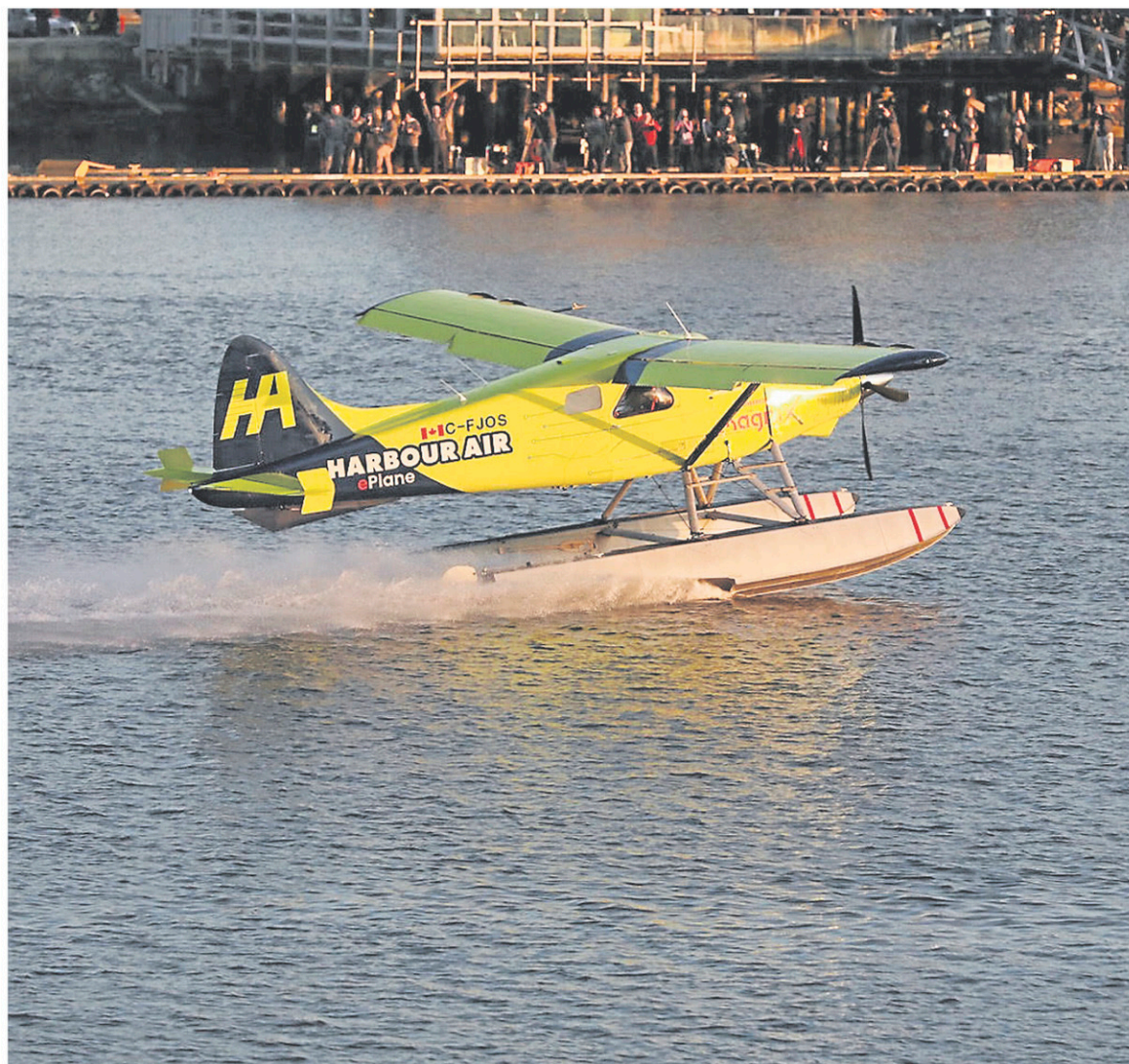
Mardi dernier, le transporteur régional Harbour Air, basé à Vancouver, a fait voler un avion De Havilland Canada DHC-2 Beaver, construit en 1956, converti à une motorisation électrique pendant trois minutes. — PHOTO FOURNIE PAR HARBOUR AIR
